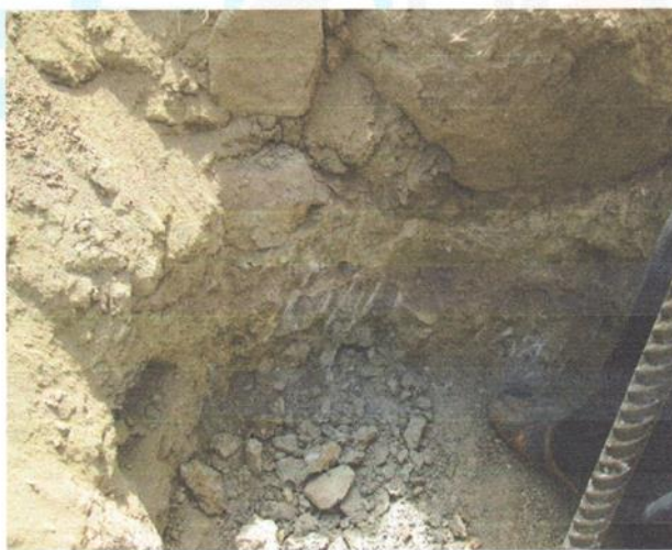
Foto N 04: Se aprecia en detalle la existencia de un estrato compacto en la calicata C-02
