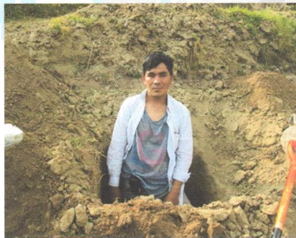
Foto N 06: Se aprecia la profundidad de excavación de la calicata C-04.
