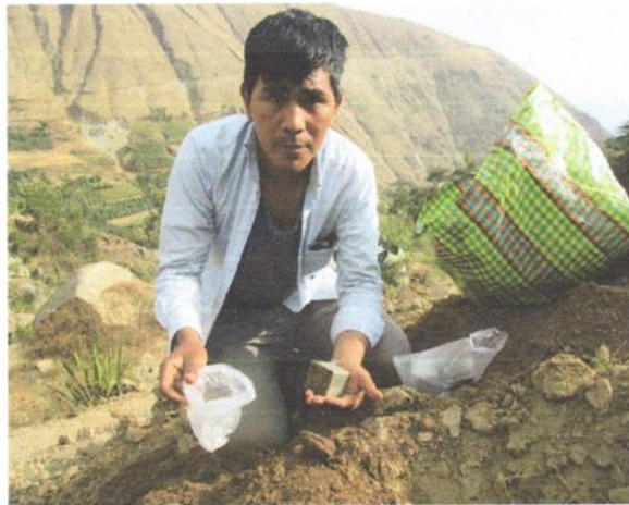
Foto N 05: Se aprecia la obtención d muestras en la calicata C-03
