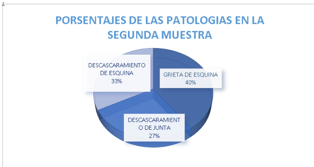
Figura 5.6: Porcentaje de las patologías existentes en la muestra N°2
