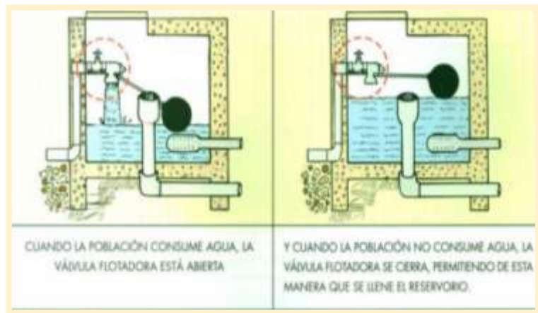
Figura 20. Cámara rompe presión
