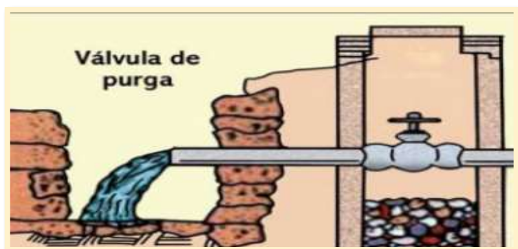
Figura 19. Válvula de purga
