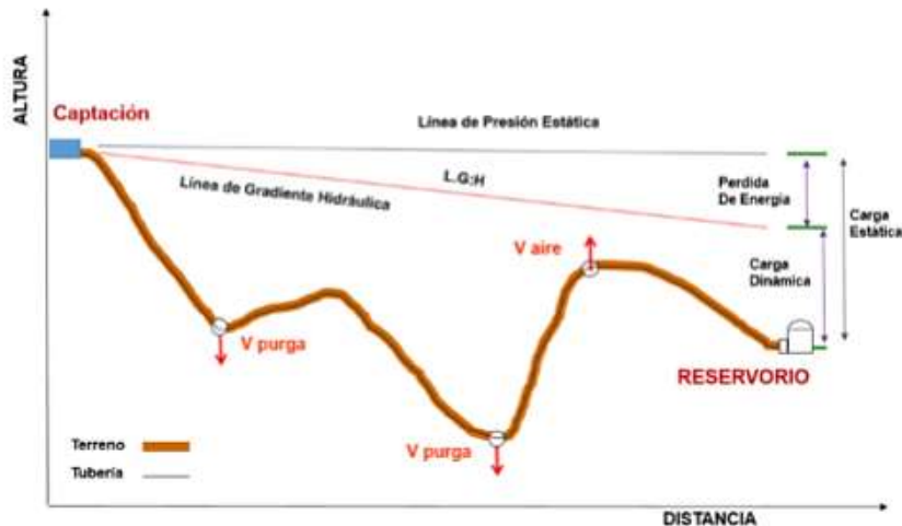
Ilustración N° 03.31. Línea de Conducción
