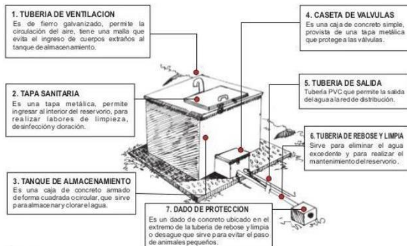
Figura 6 Partes externa del reservorio apoyado
