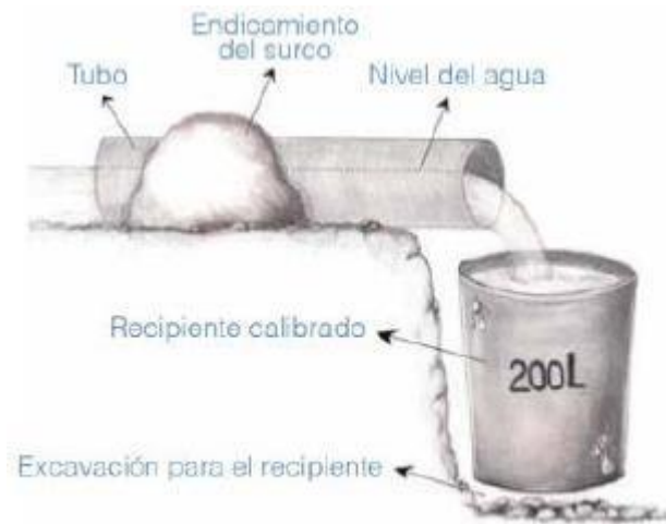
Figura 3 Obra de captación de ladera
