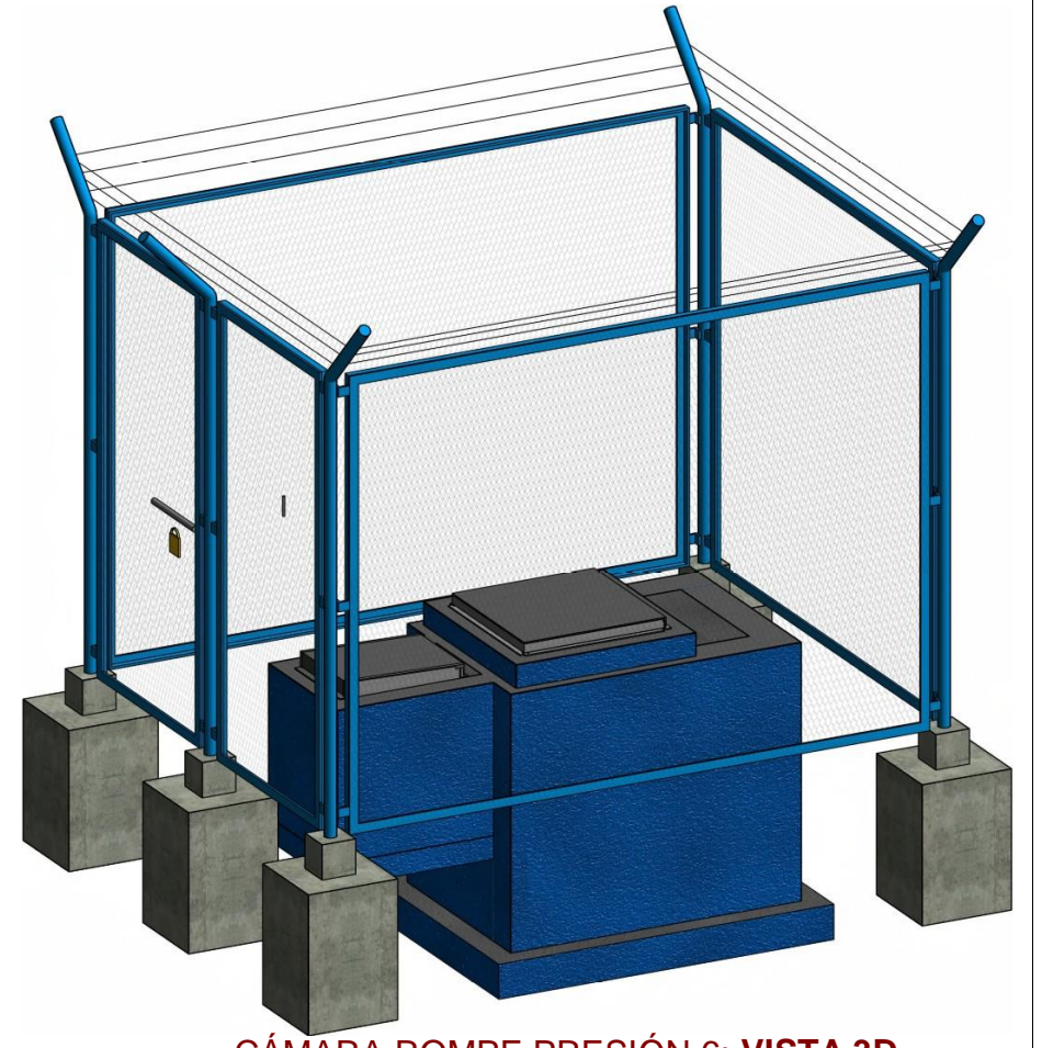
CÁMARA ROMPE PRESIÓN 6: VISTA 3D ESC. 1:10
