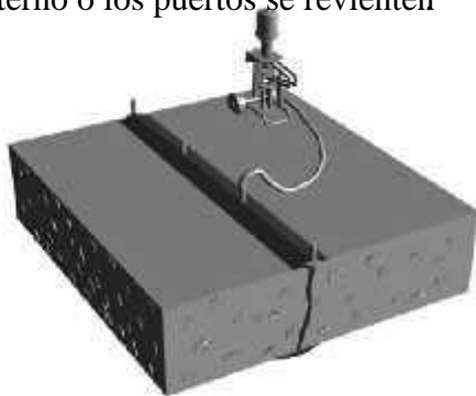
Fig. 4. Inicio de la inyección en el segmento más ancho de la grieta.
