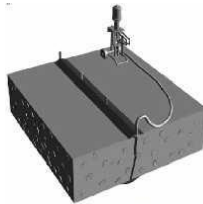
Fig. 5. Continúe la inyección hasta que ya no quede más espacio y se retire.
