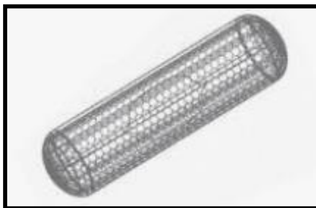
Figura 7: Gaviones tipo saco
