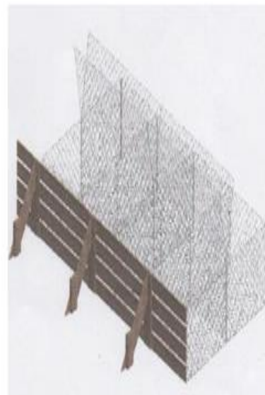
Figura 13. Encofrador posicionado junto a los gaviones. Fuente: (ACEROS METALES Y MALLAS LTDA, 2016)
