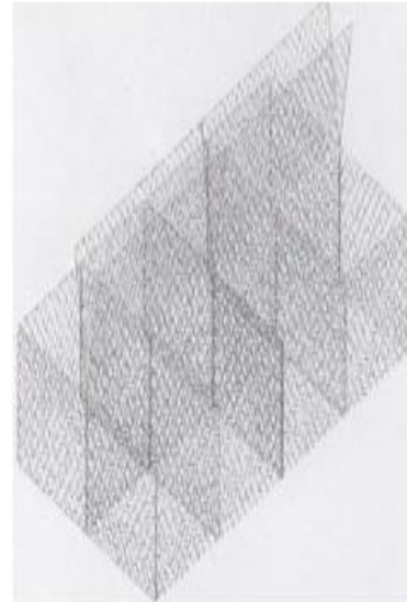
Figura 13. Amarrado entre gaviones. Fuente: (ACEROS METALES Y MALLAS LTDA, 2016)
