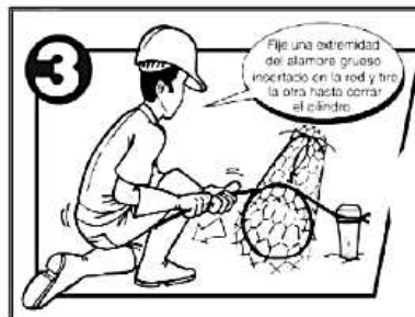
Figura 16. Amarre de los extremos. Fuente: (Morassutti F, 2013)
