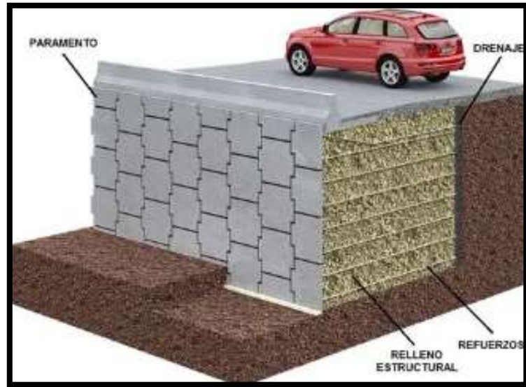
Figura 14: Muro de contención de tierra estabilizado mecánicamente Fuente: Extraído de canal de construcción.
