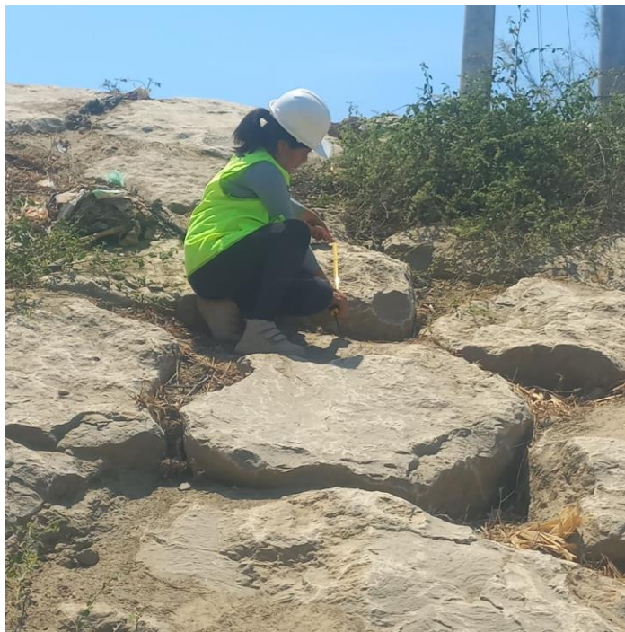
Figura N° 04: Determinación del diámetro promedio de Rocas
