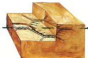
Figura 29. Efecto de corte producido por la interacción suelo-malla 7 .
