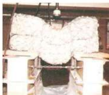
Figura 7. Prueba de resistencia de los gaviones 5 .
