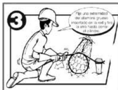
Figura 16. Amarre de los extremos. Fuente: (Morassutti F, 2013)
