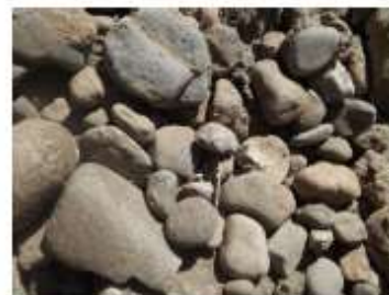
Figura 11. Rocas para el llenado de gaviones. Fuente: https://pixabay.com/es/photos/piedras-ripijo-gaviones-de-piedra-1323243/
