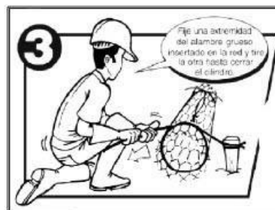
Figura 16. Amarre de los extremos. Fuente: (Morassutti F, 2013)
