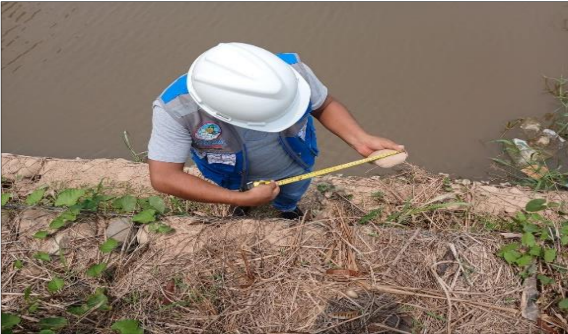
Figura 39: Se observa piedras de 7 cm que no cumple con la normativa específica
