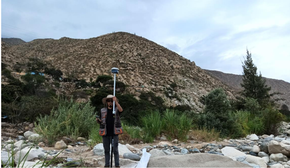
Fotografía 2. Levantamiento topográfico de los puntos de foto control.
