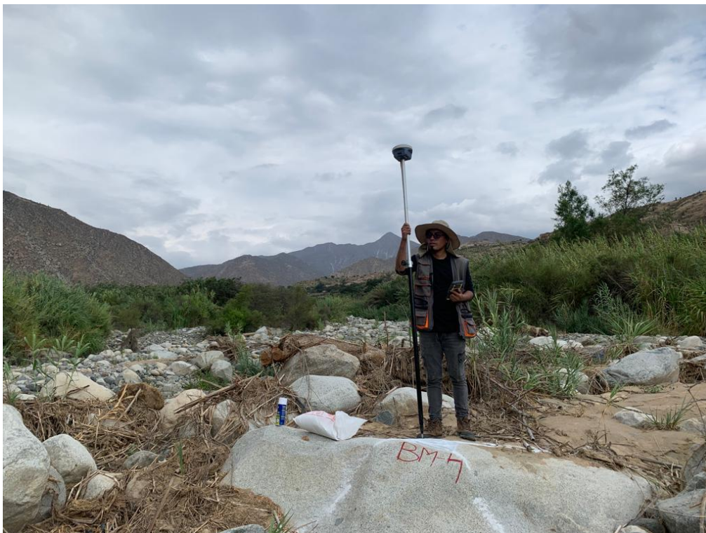
Fotografía 5. Puntos de control BM para la realización del replante.
