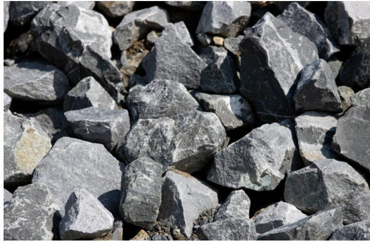
Figura 8: Piedra chancada como relleno de gavión Fuente: Extraído de la página de cantera santa Rita (32)
