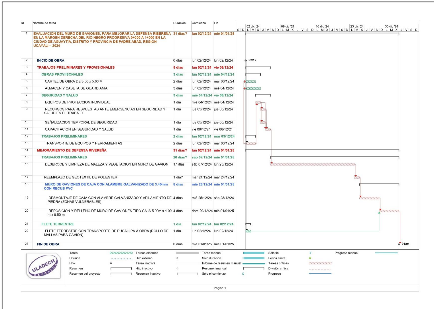
Figura 27: Programación de obra de mejoramiento de muro de gaviones Fuente: Elaboración propia 2024
