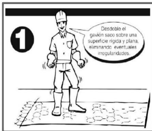
Figura 16. Preparación de malla sobre una superficie plana. Fuente: (Morassutti F, 2013)
