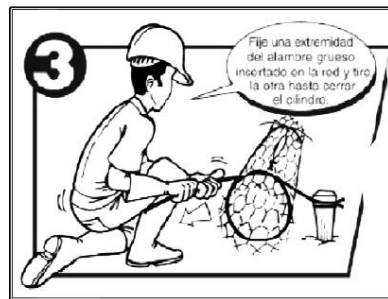
Figura 16. Amarre de los extremos. Fuente: (Morassutti F, 2013)
