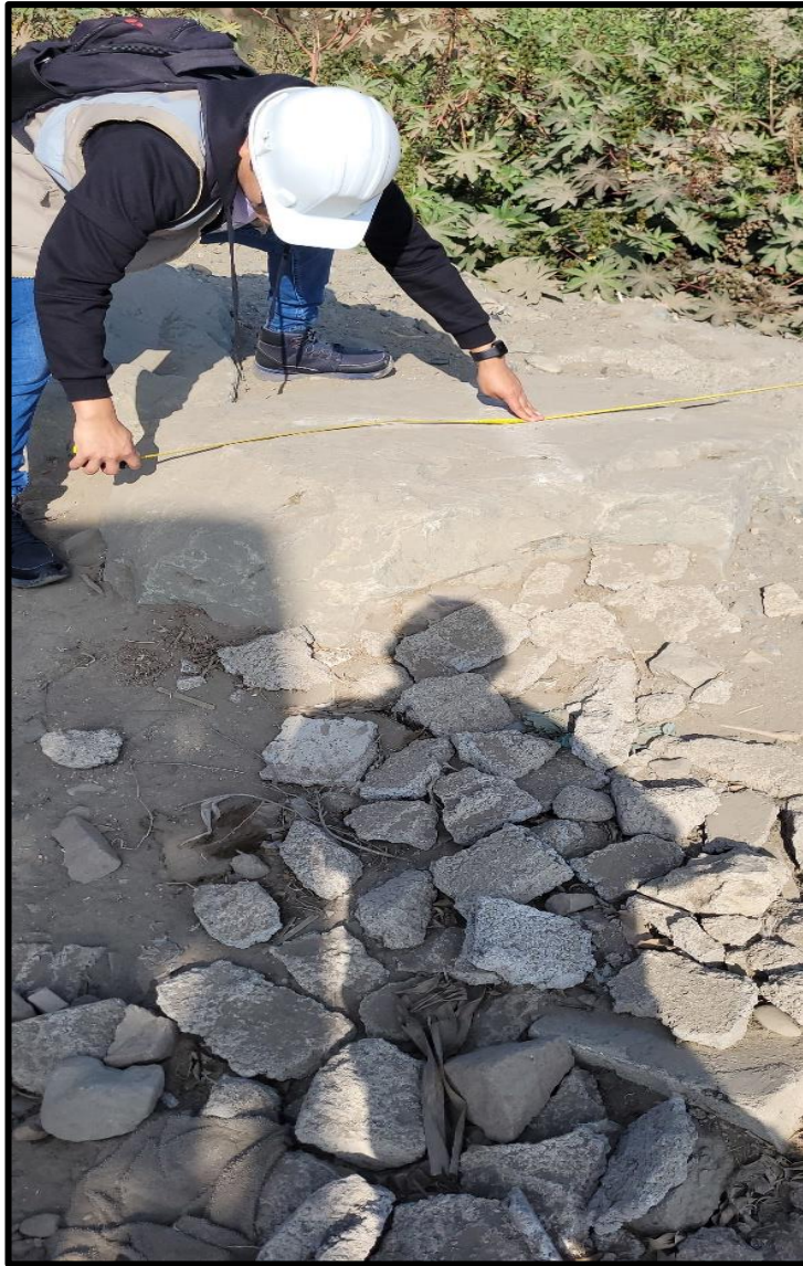
Figura 34: Realizando la medición con wincha de las rocas del tramo 1.
