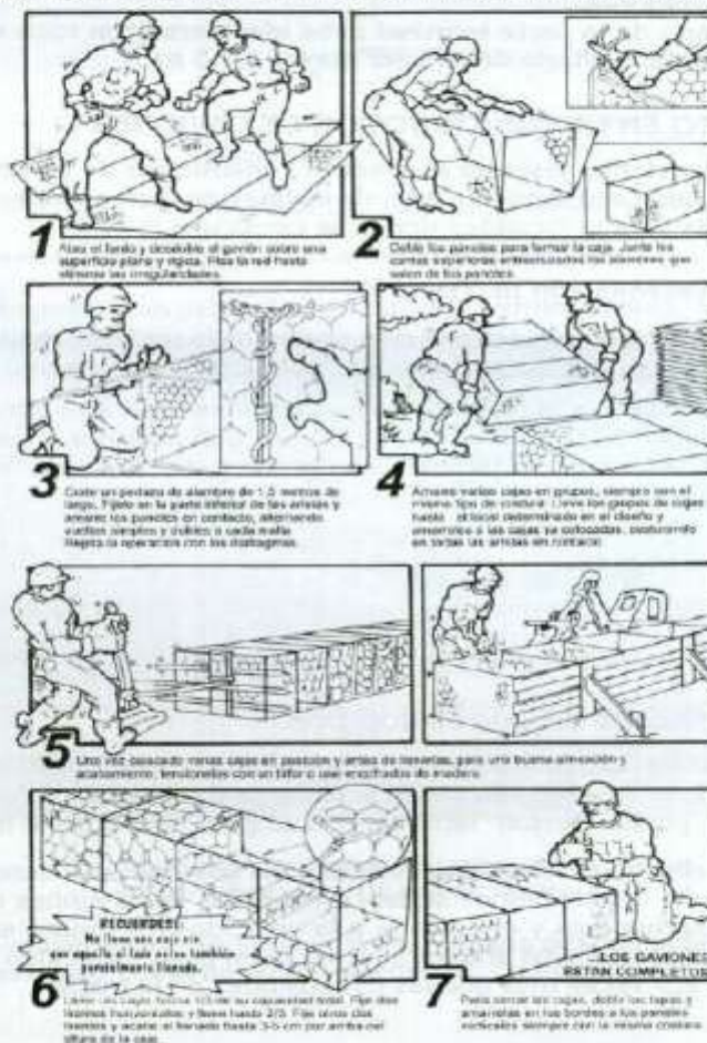
FIGURA N°29. COLOCADO Y LLENADO DE GAVIONES
