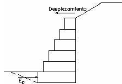
Figura 18. Efecto del empuje pasivo 3 .
