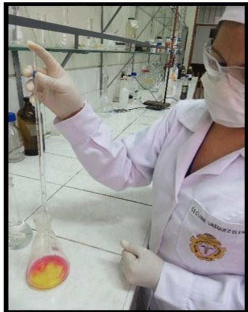
Luego se adiciona 1 ml. de cloruro de hidrógeno (HCL) de 0.05 N va realizar un cambio de color, de rojo a un color amarillo.
