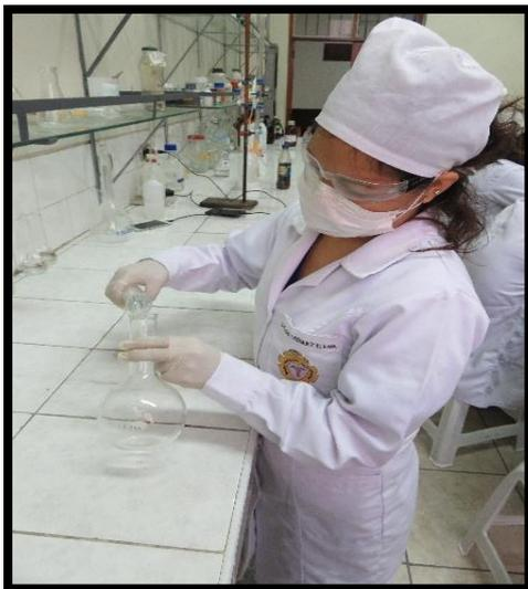
Se lleva la muestra de sal de cocina a un balón de 200ml y se afora con agua destilada, se agita bien hasta diluir.
