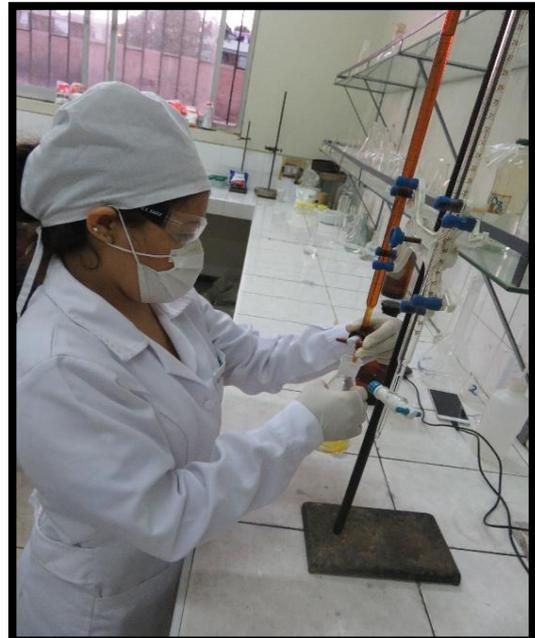
Se adiciona el reactivo  $\text{AgNO}_3$  de 0.01 N en la bureta de 50 ml. llenar los 50 ml. con el reactivo y colocar en el soporte para luego leer los resultados.
