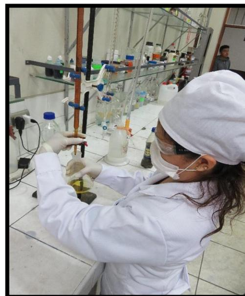
Luego colocamos el matraz con la solución de sal con indicador debajo de la bureta y abrimos lentamente la llave de paso para así hacer la reacción paso a paso agitando el matraz hasta que se realice el cambio de color ese cambio de color se conoce como punto final, aquí la reacción ya se completó y luego vemos el gasto en la bureta, mediante la fórmula química  $50 \text{ ml} = 2N$  por el gasto en la bureta nos sale el resultado final.
