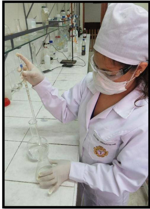
Se toma una alícuota de 10ml. con una pipeta y se coloca en un matraz volumétrico de 250ml.
