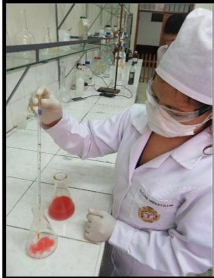
A la solución se agrega con la pipeta 1 ml. de indicador rojo de fenol
