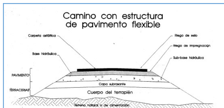
Figura N° 03: Sección De Pavimento Flexible
