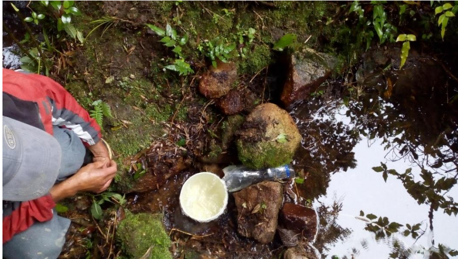
Ilustración 15: Calculando el aforo del manantial, por el método volumétrico. Fuente: Propia
