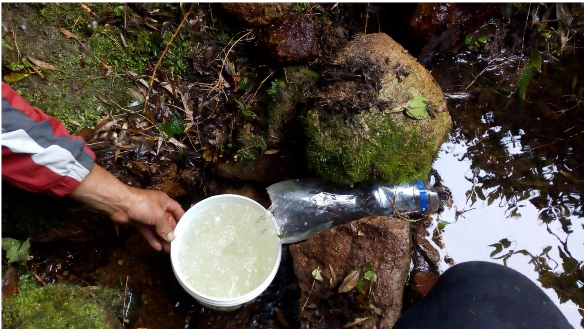
Ilustración 19 y 20: Realización de aforo del manantial MACHO MUERTO; dando como resultado 1.10 l/s.
