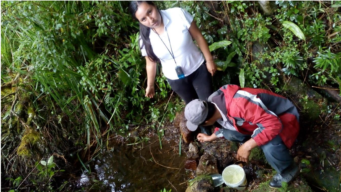
Ilustración 19 y 20: Realización de aforo del manantial MACHO MUERTO; dando como resultado 1.10 l/s.
