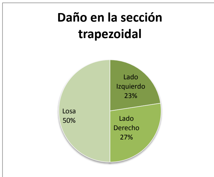
Gráfico 54. Distribución del daño en los elementos de la sección trapezoidal
