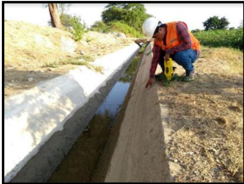
Gráfico 53: Midiendo las dimensiones del canal.
