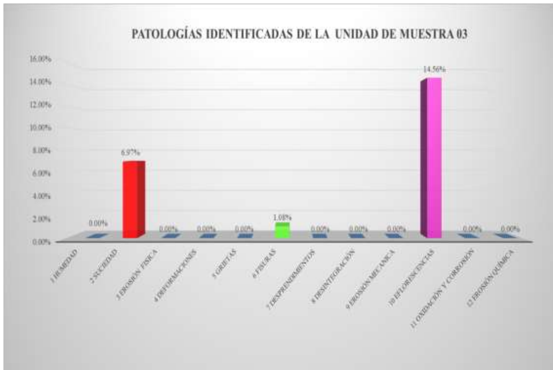
Gráfico 13: Patologías identificadas de la unidad de muestra 03
