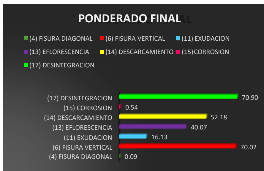
figura 36. Ponderado final de las patologías encontradas en columnas.
