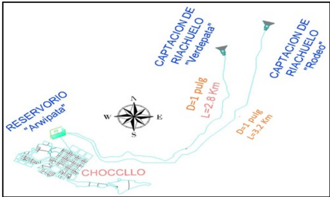
Figura 4.10: Sistema de Agua Potable- Choccllo
