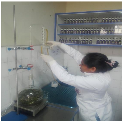
Imagen 05: Extracción del aceite esencial en el equipo de clevenger
