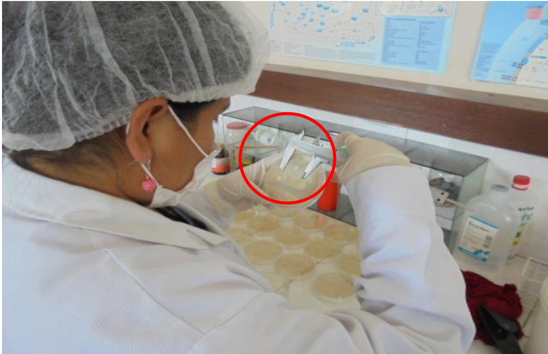
Imagen 14: Lectura de los halos inhibición con el vernier
