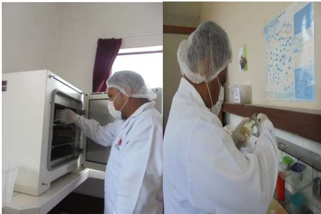
Figura 05: Derecha, realizando la colocación de las placas Petri en la incubadora. Izquierda tomando lectura de los halos de inhibición después de las 24 horas de la siembra.
