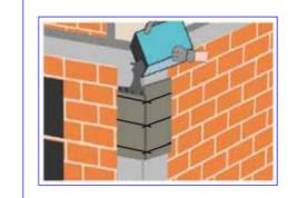
Para posteriormente aplicar un mortero de alta resistencia, previamente se aplicara una resina epoxica, para garantizar la adherencia del material nuevo con el viejo, asi mismo se debe de aplicar una proteccion superficial en la parte reparada.
