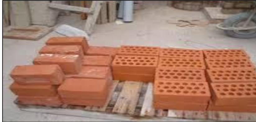
**Figura 10.** Unidades de albañilería.
