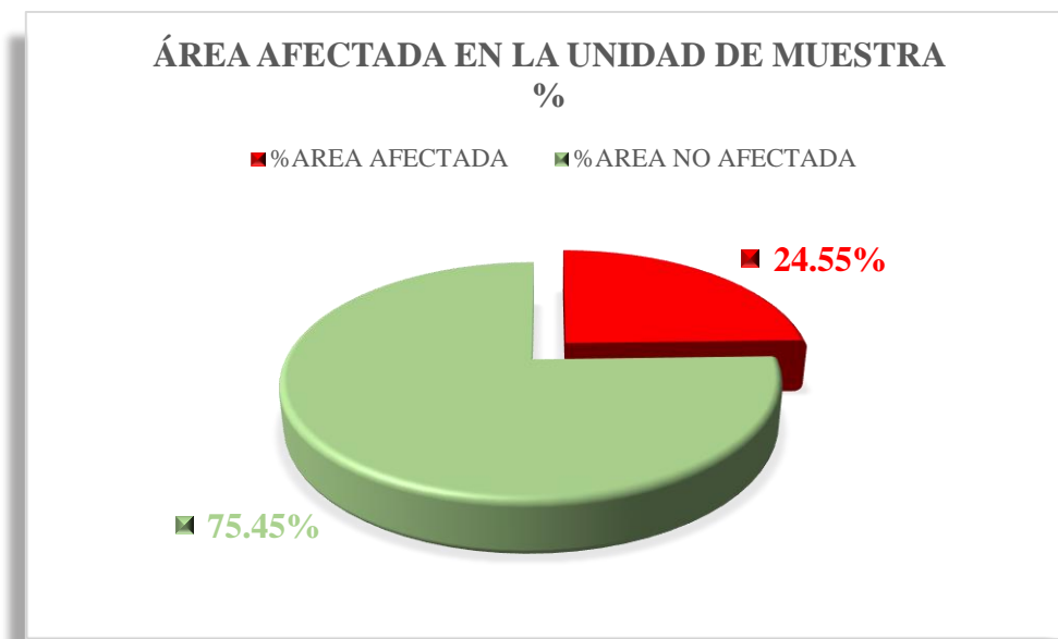
Figura 90. Área afectada de la unidad de muestra 15 en porcentaje. El área afectada total es de 24.55%. Fuente: Elaboración propia (2018).
