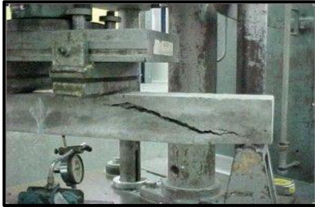
Figura 19. Prueba de resistencia del concreto – México. Fuente: Arqhys (2013).
