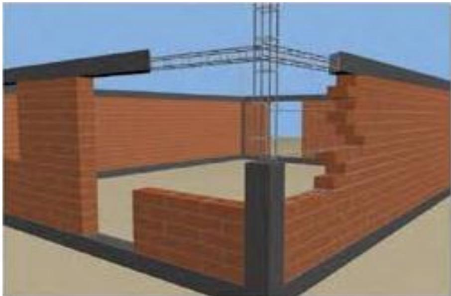
Figura 03. Albañilería reforzada
