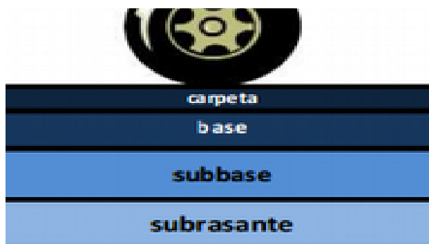
Figura N° 0 1 Paquete estructural de un pavimento flexible
