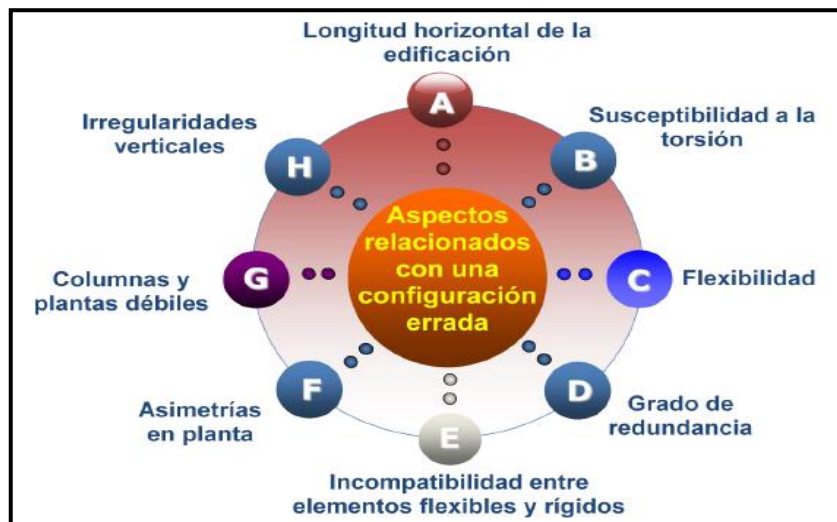
Imagen N° 19: Aspectos que deben cuidarse en el diseño de una estructura esencial
