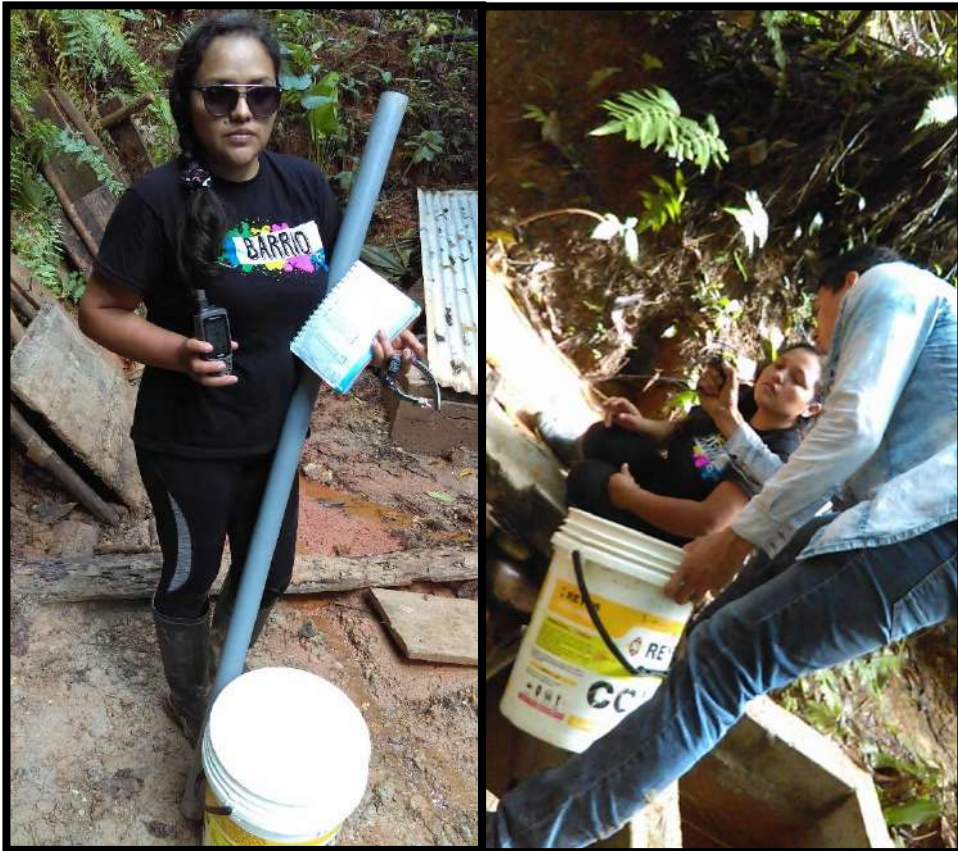
Figura 24: Aforo de la fuente por el método volumétrico, con los materiales necesarios. Fuente: Elaboración propia
