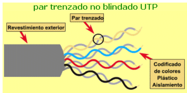
Grafico Nro. 7: Par trenzado sin apantallar (UTP)
