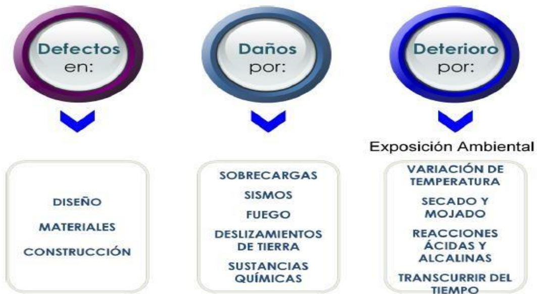
Imagen 1. Clasificación general de patologías en las edificaciones
