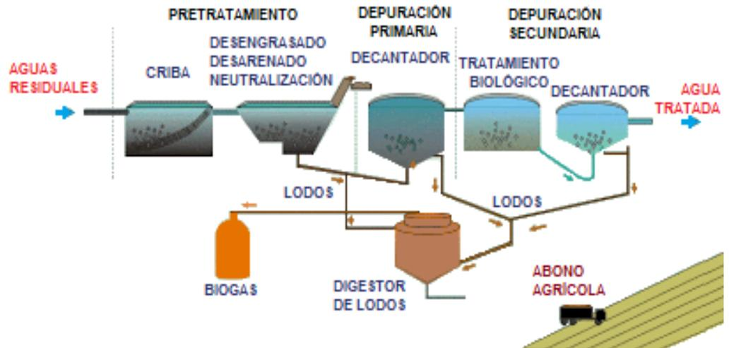
**Figura N° 5.** Esquema convencional de Planta de tratamiento de aguas residuales
