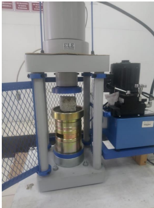
Gráfico 38. Muestra de concreto y prensa hidráulica.
