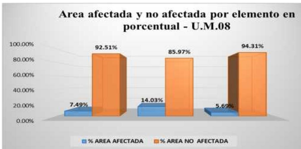
**Interpretación:** Con mayor área afectada es la solera con 0.95m2, que equivale a 14.03%, y con área no afectada de 5.80m2. de igual forma que equivale a 85.97%.
