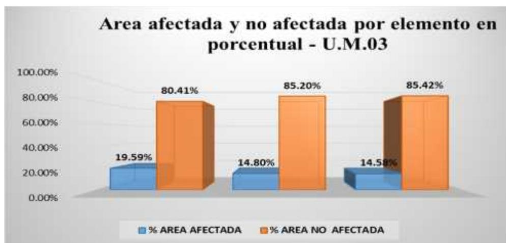
**Interpretación:** Con mayor área afectada es el talud derecho con 1.32 m2, que equivale a 19.59%, y con área no afectada de 5.43m2. de igual forma que equivale a 80.41%.
