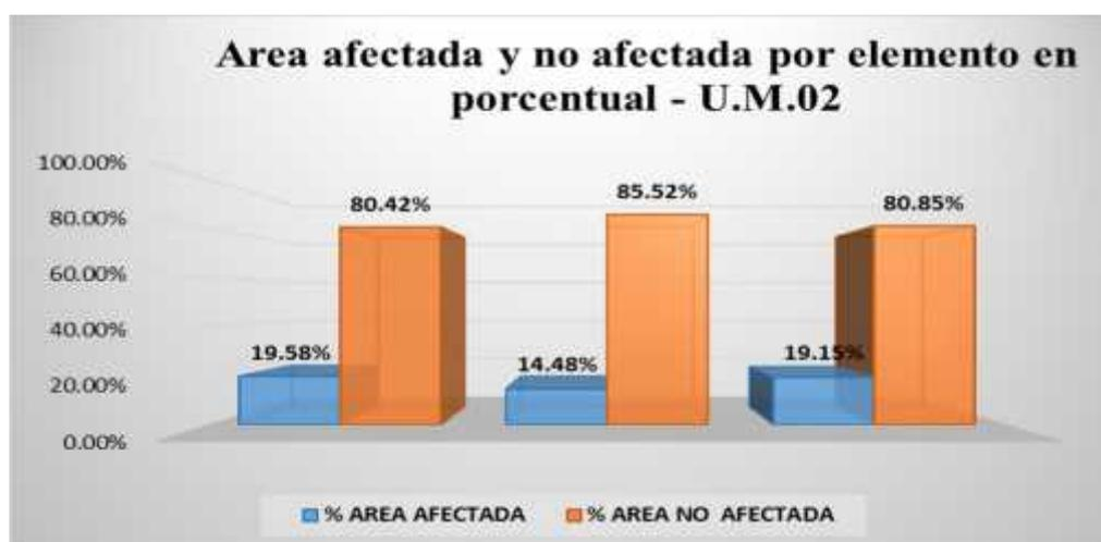
**Interpretación:** Con mayor área afectada es el talud derecho con 1.32 m2, que equivale a 19.58%, y con área no afectada de 5.43m2. de igual forma que equivale a 80.42%.
