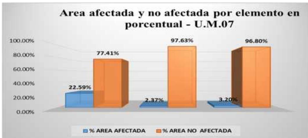
**Interpretación:** Con mayor área afectada es el talud derecho con 2.52m2, que equivale a 22.59%, y con área no afectada de 5.23m2. de igual forma que equivale a 77.41%.
