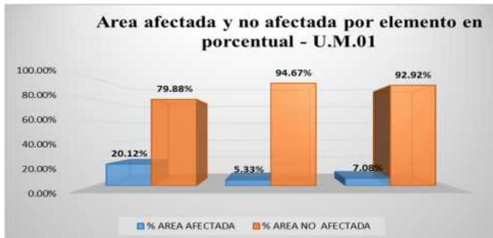
**Interpretación:** El talud derecho tiene un área afectada de 1.36 m2, que equivale a 20.12%, y con área no afectada de 5.39m2. de igual forma que equivale a 79.88%.
