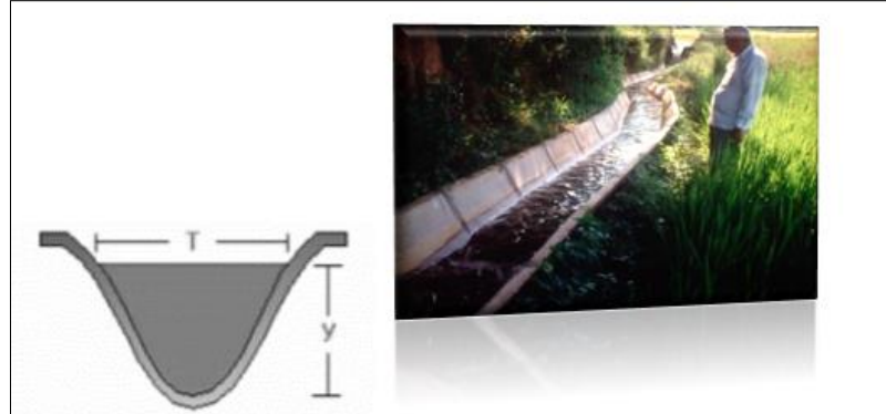
Figura 06: sección parabólica del canal
