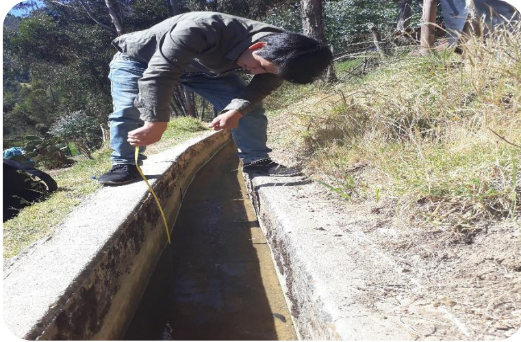
Fotografía 04: Realizando la medición de la sección del canal.
