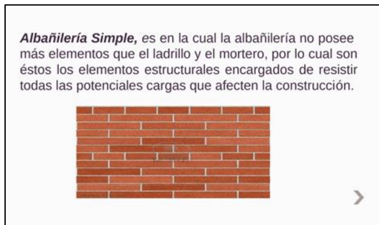
Fig. 3 Muros no reforzados
