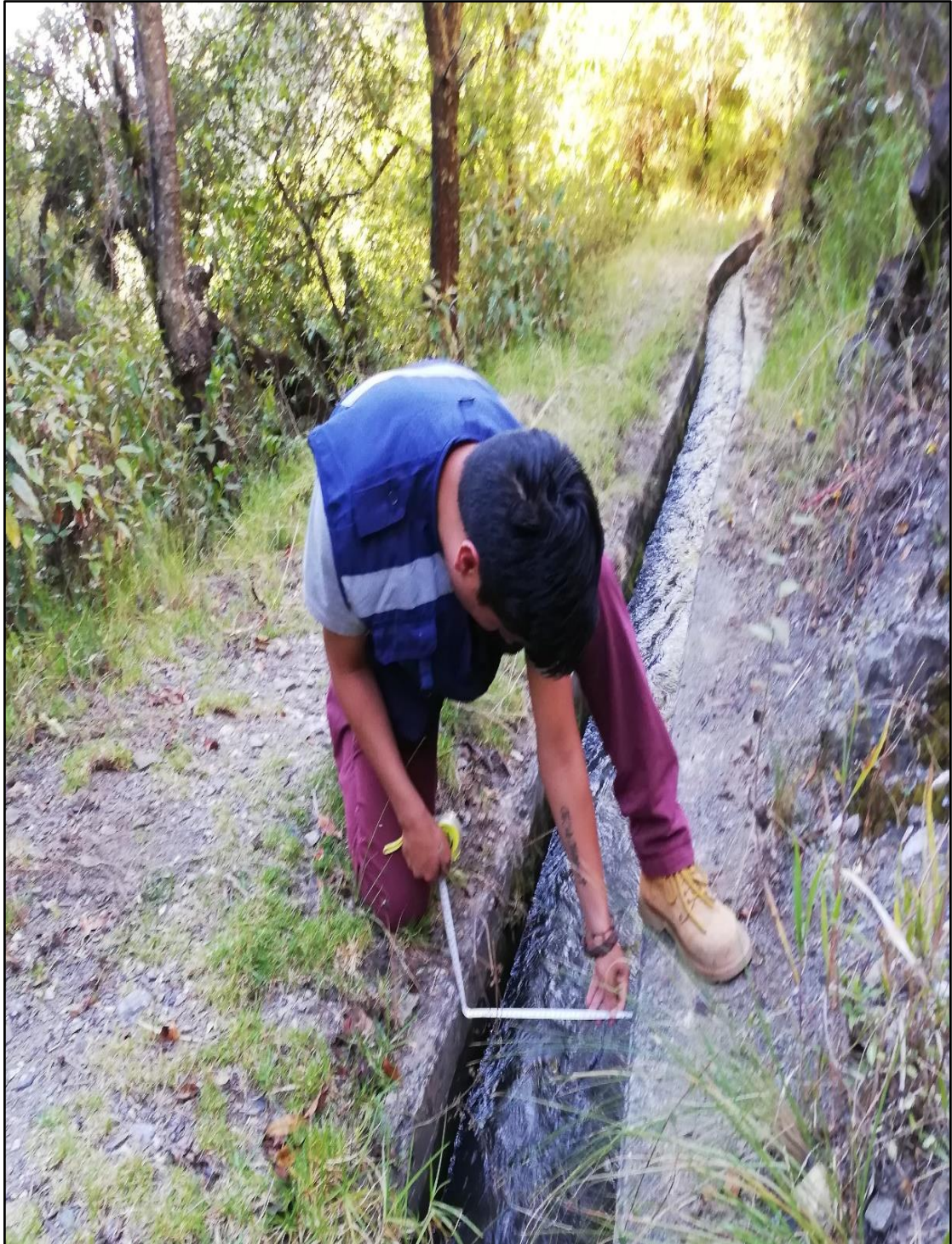
Fotografía 03: En esta fotografía se puede apreciar la toma de medidas correspondientes al canal de riego Monterrey.
