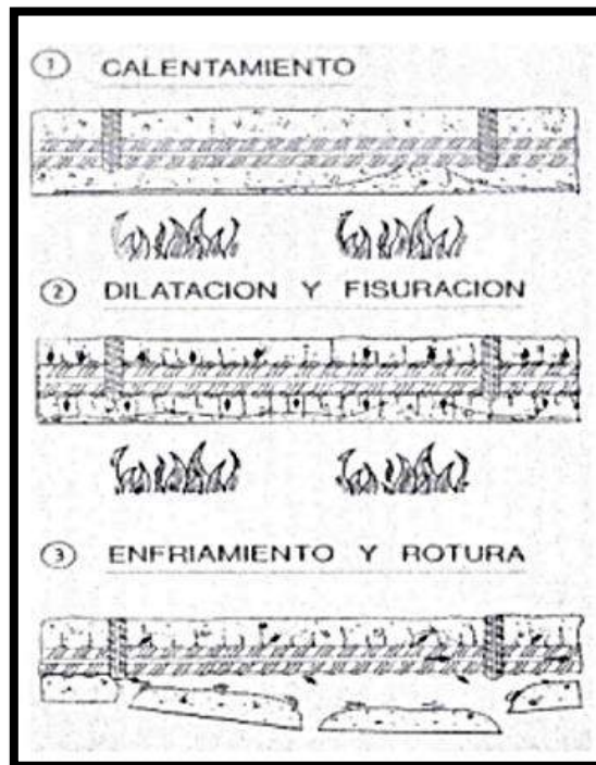
Gráfico 15: daños a la adherencia
