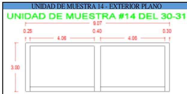
DESCRIPCIÓN DE LA UNIDAD DE MUESTRA: La unidad de muestra consta de 2 paños, con medidas de 4.06m . Dicha muestra consta de 2 columnas, 2 vigas, 2 muros de ladrillo y 2 sobrecimientos. La muestra se ubica en la parte exterior del coliseo.
