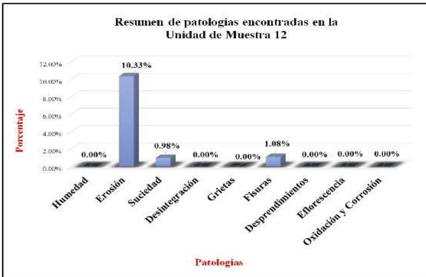
Gráfico 59: Resumen de patologías encontradas en la Unidad de Muestra 12.
