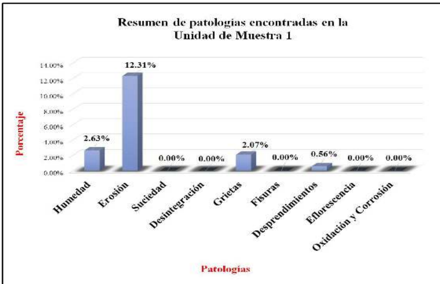
Gráfico 15: Resumen de patologías encontradas en la unidad de muestra 1.
