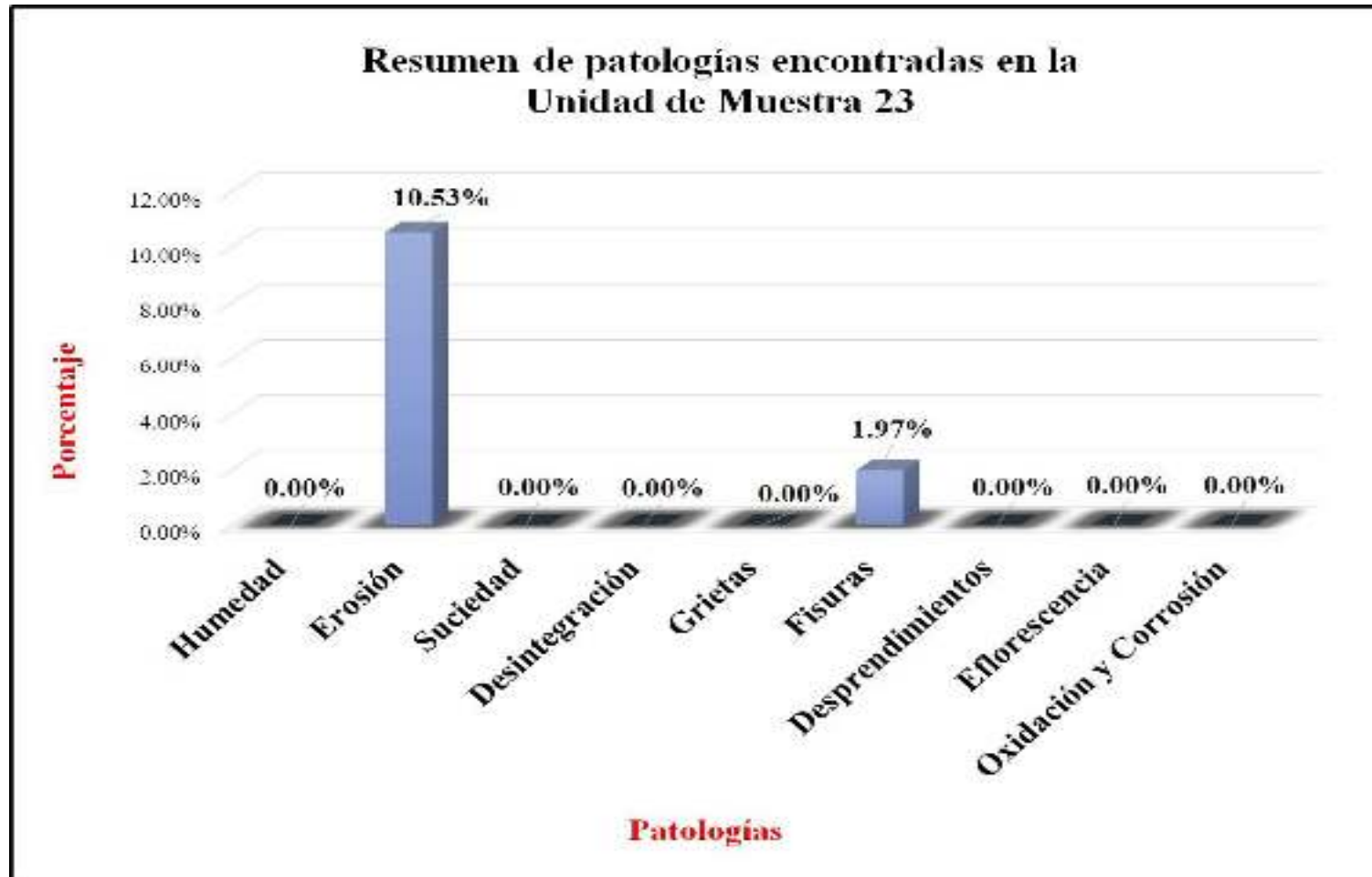
Gráfico 103: Resumen de patologías encontradas en la Unidad de Muestra 23.
