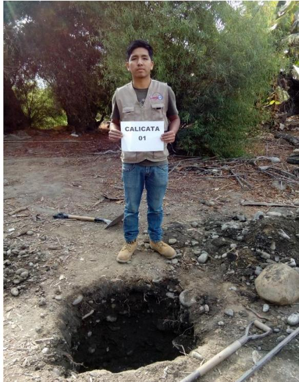
**Imagen 15:** Podemos apreciar la toma de muestra de la Calicata 01 a 3 metros de la captación, para su ensayo de mecánica de suelos.
