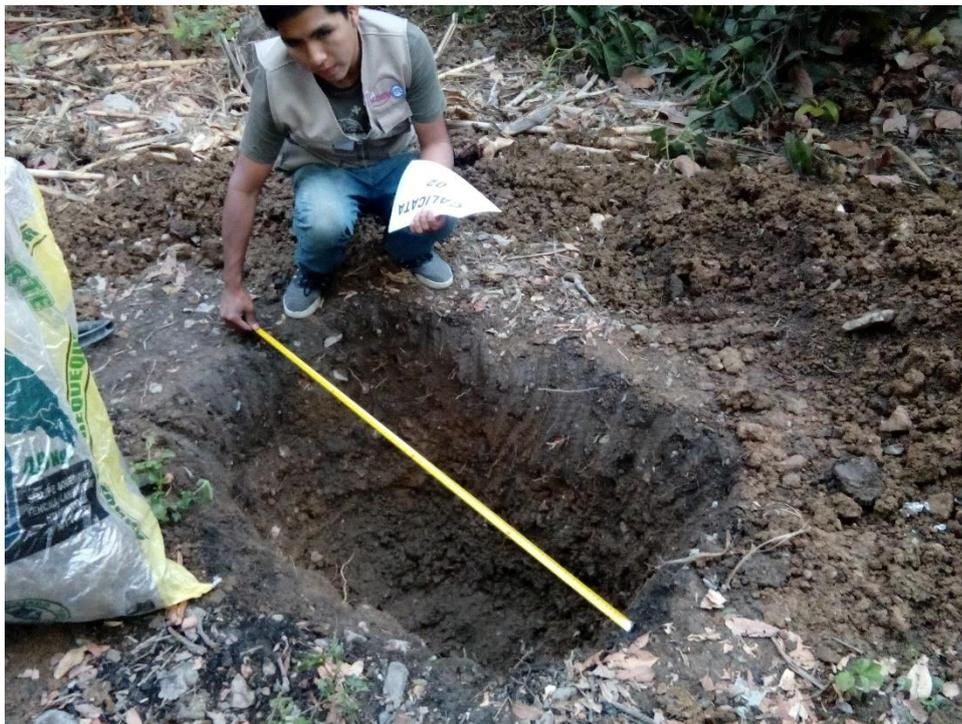
**Imagen 18:** Podemos apreciar las medidas 1m x 1m x 1m, como dice la norma para ensayo de mecánica de suelos.
