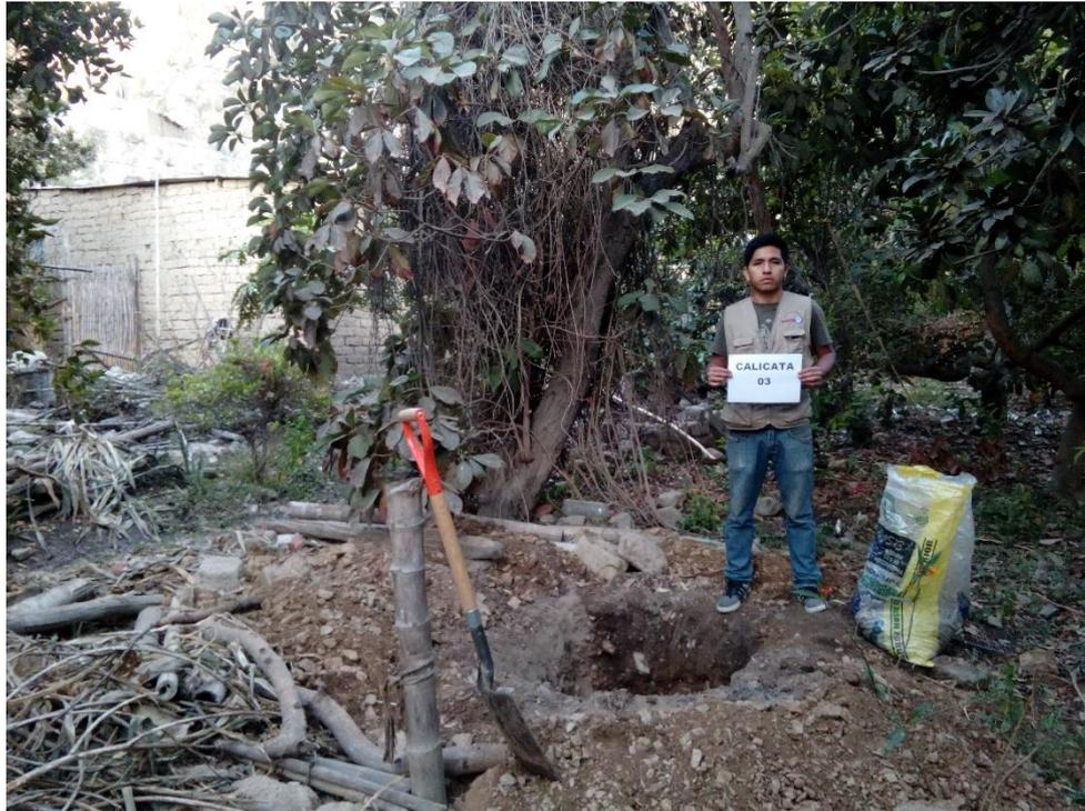
**Imagen 17:** Podemos apreciar la toma de muestra de la Calicata 03 en el caserío Racrao Bajo, para su ensayo de mecánica de suelos.
