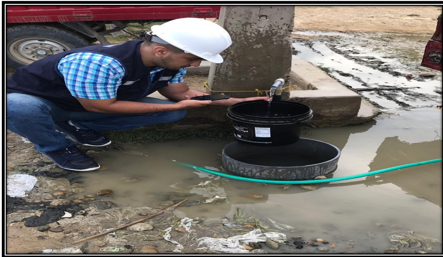
Gráfico 20: Calculando el caudal del aforo.
