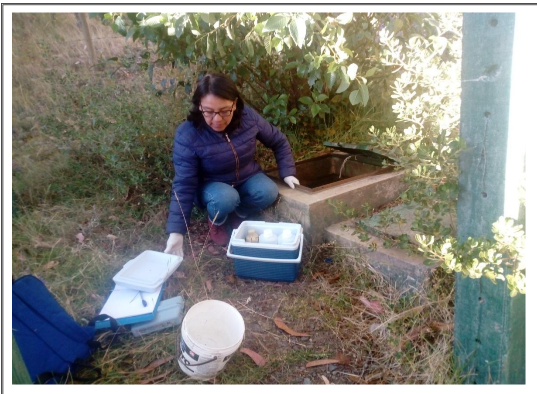
Fotografía N° 16: Toma de muestra de agua en la captación del barrio de Santa Rosa – Yancoshca.
