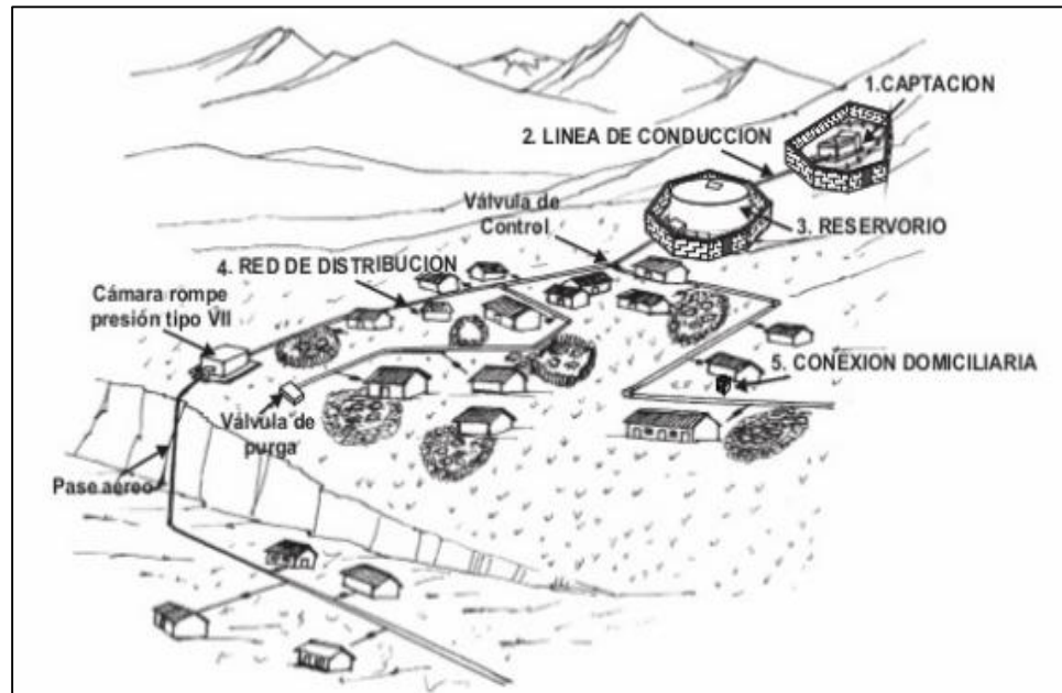
Figura N° 05: Partes de un sistema de agua
