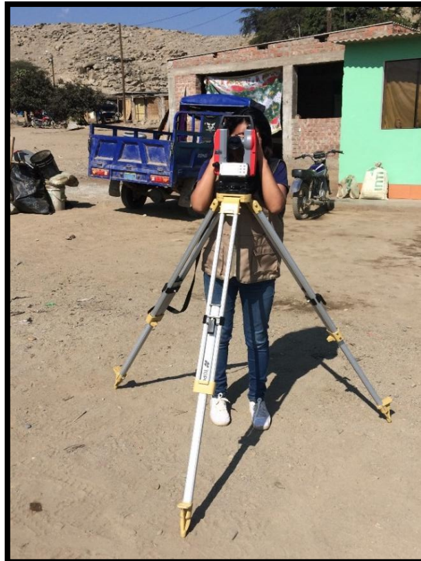
Imagen 12. Levantamiento topográfico del caserío de Vichamarca, con el uso de teodolito.
